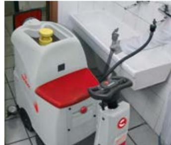
Frischwassertank mit Schnellbefüllsystem.
