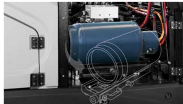
Der Motorbereich ist leicht zugänglich. Bei der Bi-Fuel-Ausführung gibt es ein entsprechendes Fach zum Verstauen der Flüssiggasflasche. Die Gasflasche kann über eine bequeme Halterung, die nach außen gedreht wird, entfernt werden.
