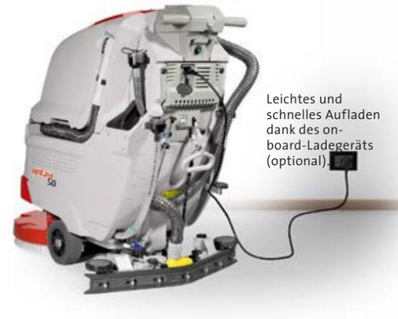
Den Füllstand der Tanks immer im Blick: der Indikator zeigt an, wann der Frischwassertank wieder befüllt und somit auch der Schmutzwassertank entleert werden müssen.
