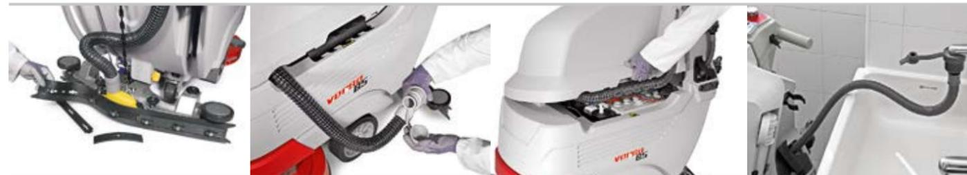
Werkzeugloses Wechseln bzw. Drehen der Sauggummis in kürzester Zeit (4-fach verwendbar).
