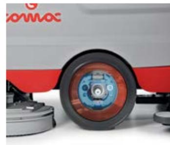
Hydraulische Bremse, die auf die Hinterräder wirkt und somit für höhere Sicherheit und mehr Komfort sorgt.
