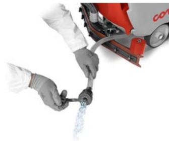
Leichte Entleerung des Frischwassertanks über einen Schlauch.
