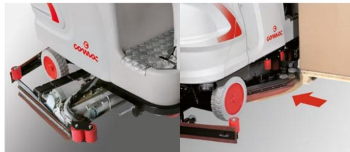
Leicht wechselbarer Walzenbürstkopf Schwingend gelagerter Bürstkopf. (Schrubben und Kehren).
