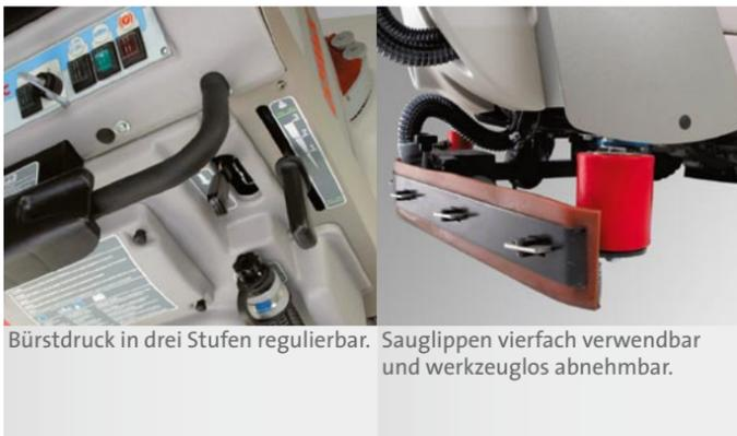
Bürstdruck in drei Stufen regulierbar. Sauglippen vierfach verwendbar und werkzeuglos abnehmbar.
