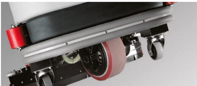
Antrieb über Vorderrad mit Gleichstrommotoren. Auf allen Ultras serienmäßig Anti-Skid-Räder.
