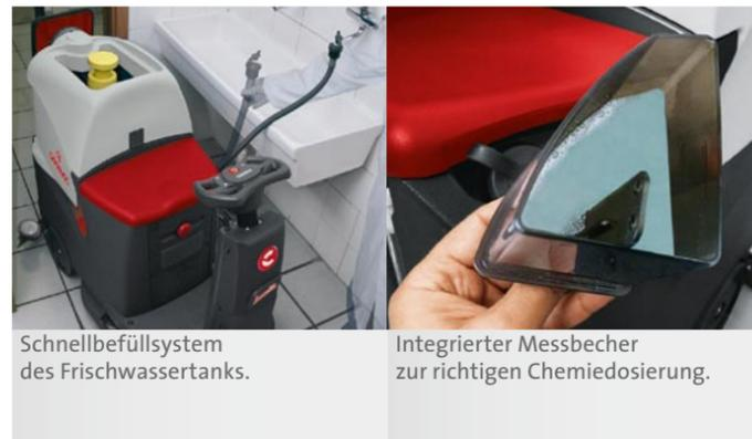
Schnellbefüllsystem des Frischwassertanks.
