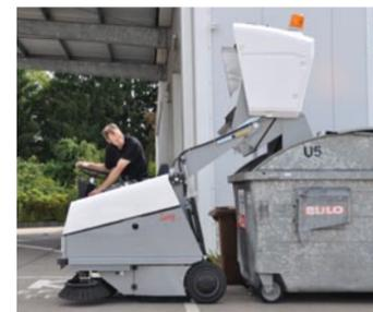
Hydraulische Hochentleerung bis maximal 147 cm und maximal 400 l. Hier die Sweep CS 100 AHB.
