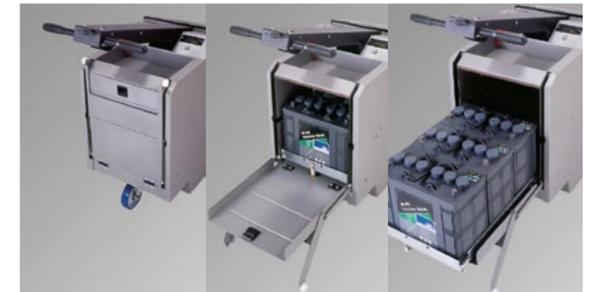
3x12 V 105 Ah versorgen die Polimax mit genügend Energie. Wenn Sie mehr brauchen: Batteriewechselsystem integriert.
