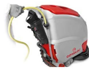
Schnelle Frischwasserbefüllung durch serienmäßigen Schlauchanschluss.
