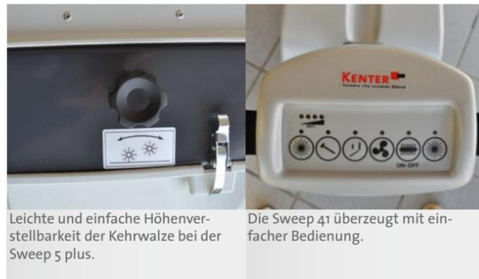
Leichte und einfache Höhenverstellbarkeit der Kehrwalze bei der Sweep 5 plus.
