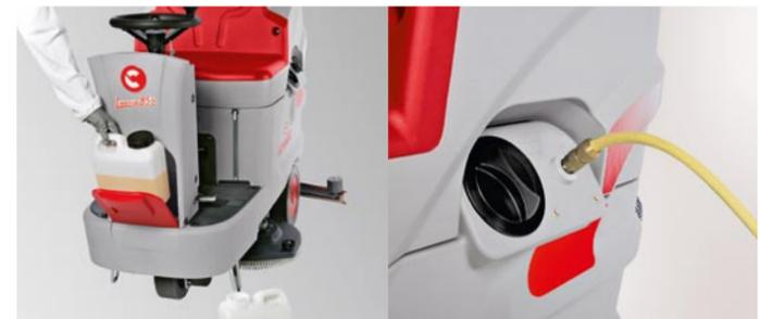
Die Innova 65 / 75 / 85 B Modelle sind mit dem Comac Dosier System (CDS) für Wasser- und Chemiedosierung ausgestattet. Schnelle Tankbefüllung mit Schlauch über separaten Anschluss.
