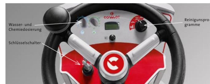
Das Bedienpult der Modelle 65 / 75 / 85 B in der Automatikversion. Links Wasser- und Chemiedosierung. Rechts Auswahl des Reinigungsprogramms (Fahren, Absaugen, Schrubben und Absaugen, nur Schrubben).
