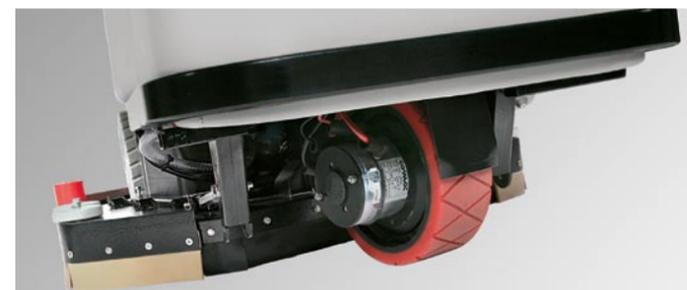
Antrieb über Vorderrad mit der Möglichkeit auch auf nassem Untergrund sicher zu fahren. Leichtgängige Lenkung und kleiner Wendekreis machen ein einfaches Manövrieren auch in engen Arbeitsumgebungen möglich.
