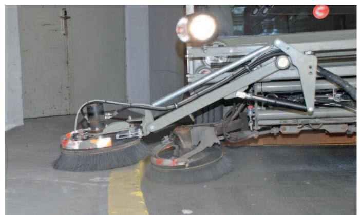
Mit dem schwenkbaren Seitenbesen lassen sich in einem Arbeitsgang Flächen auf unterschiedlichem Höhenniveau reinigen.
