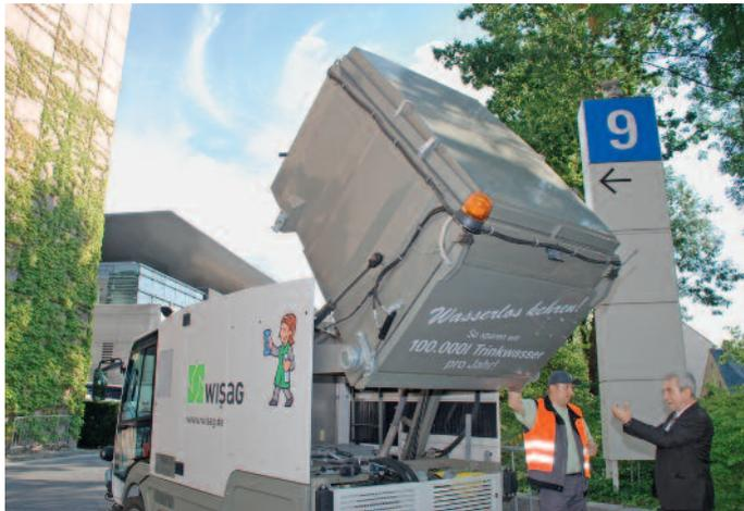
Alle Wartungselemente sind leicht zugänglich, sobald der Kehrgutbehälter angehoben wird. Beispiel Kehrwalzenwechsel: Seitenklappe auf, Walze raus, neue rein, Klappe zu. „Fünf Minuten“, sagt Martin Strzedulla, „höchstens.“
