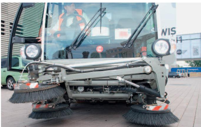
Wasser muss im Kehrprozess nicht zugesetzt werden. Eine starke Turbine saugt den Schmutz in den Kehrgutbehälter. Ein großer Filter sorgt dafür, dass auch feinste Partikel aufgefangen und nicht wieder abgegeben werden.
