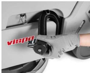
Der Schmutzwassertank ist mit einem Griff zum Anheben und Entleeren ausgestattet. Der SW-Tank der Vispa XL kann auch über den Schlauch seitlich entleert werden.
