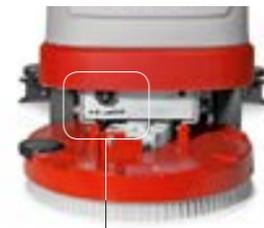
Einfache, werkzeuglose Einstellung des Vortriebs, passend für jeden Boden (Antea 50 E/B/BT).
