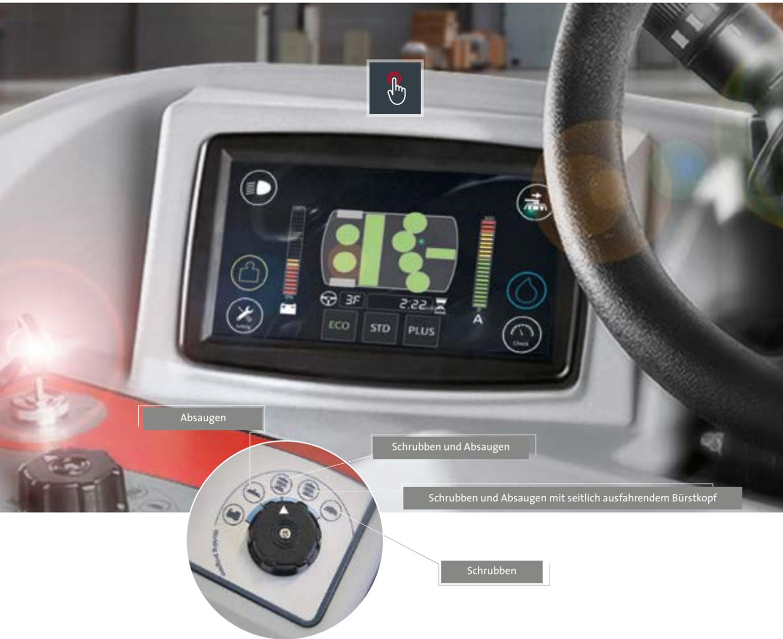
Die Bedienung der C130 ist intuitiv, praktisch und einfach. Über den Arbeitsprogramm-Drehschalter wird manuell die Tätigkeit gewählt, die ausgeführt werden soll: Nur Schrubben, nur Absaugen, Schrubben und Absaugen oder Schrubben und Absaugen mit seitlich ausfahrendem Bürstkopf.
