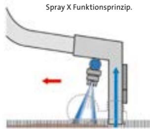
Spray X 12 brush: die Reinigungsleistung wird durch die Walzenbürste verstärkt.
