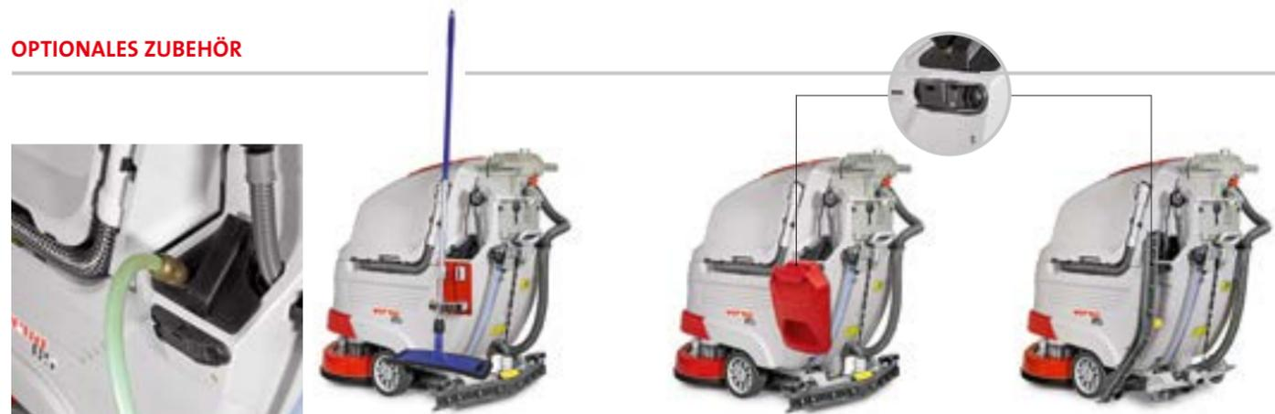
Schnellbefüllsystem (optional): der Bediener muss während des Befüllens nicht anwesend sein.
