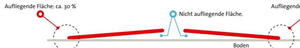
Produktivitätseinbußen und evtl. Beschädigungen am Boden aufgrund der starken und einseitigen Drehbewegung.
