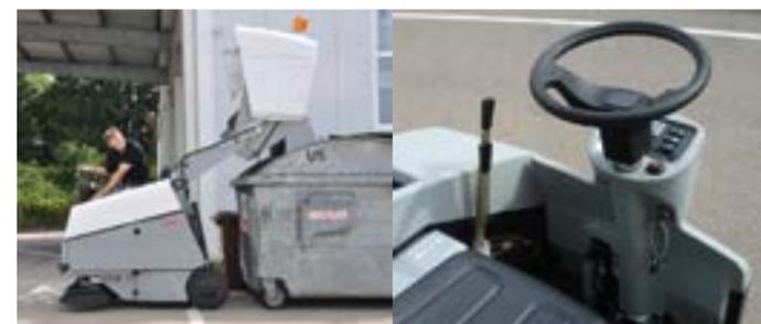
Hydraulische Hochentleerung bis maximal 158 cm und maximal 470 l (Sweep 120 AHD).
