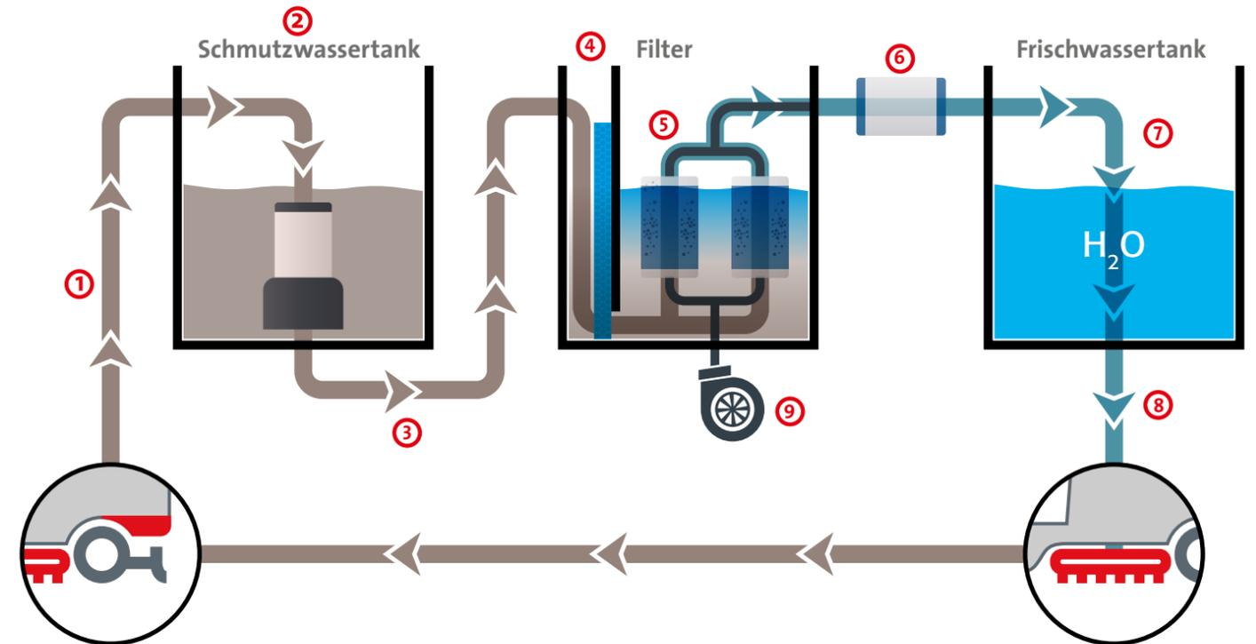
NSC 2.0 bereitet verschmutztes Wasser innerhalb der Maschine wieder für die Reinigung auf – bis zu 7 Tage ohne Nachtanken.
