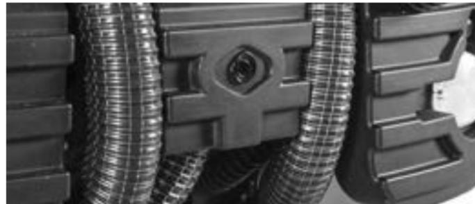
Antikollisions-Sensor für komfortable Maschinenbedienung. (Bright: optional).
