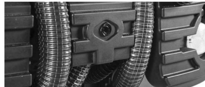
Antikollisions-Sensor für komfortable Maschinenbedienung. (Bright: optional).
