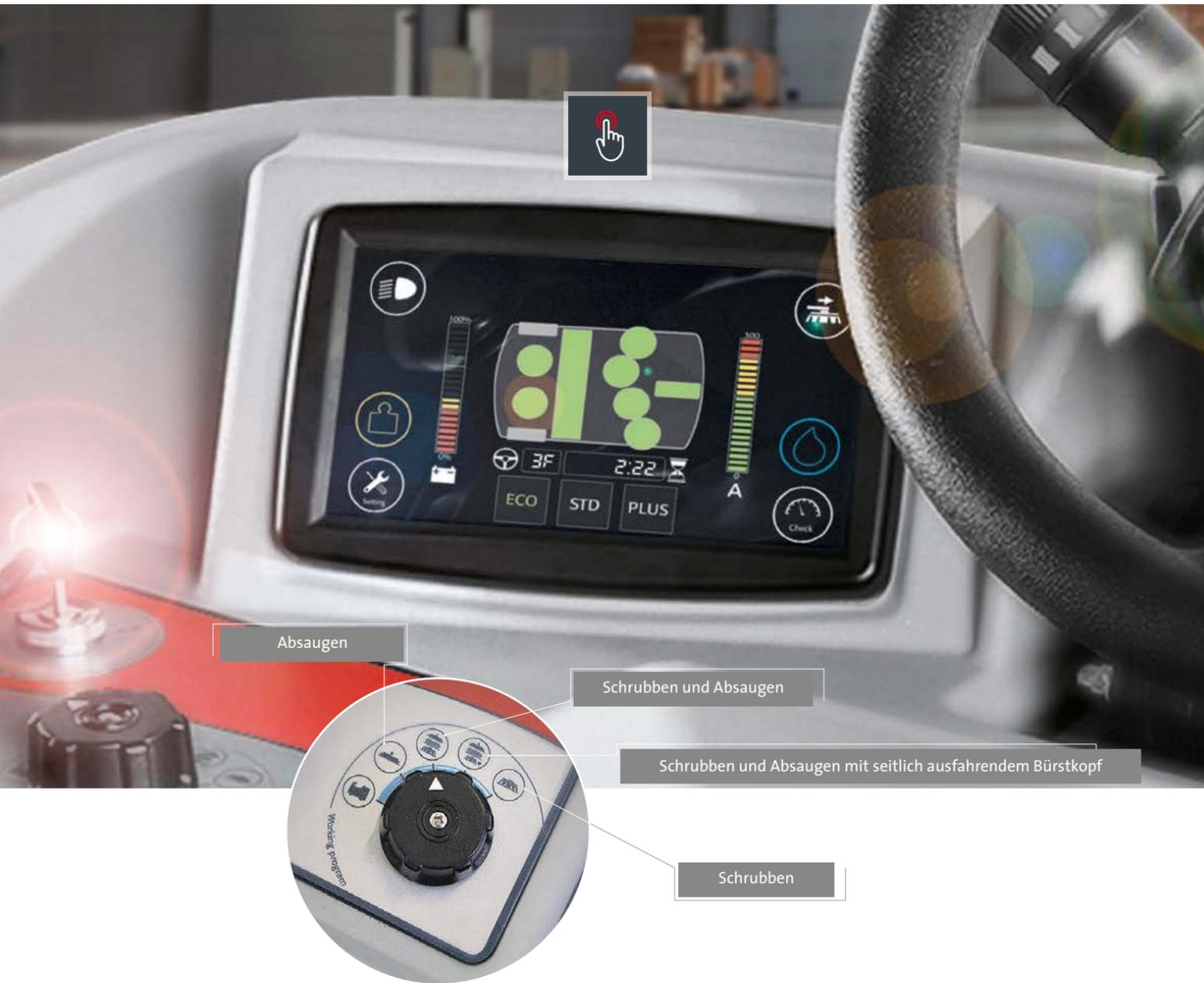
Die Bedienung der C130 ist intuitiv, praktisch und einfach. Über den Arbeitsprogramm-Drehschalter wird manuell die Tätigkeit gewählt, die ausgeführt werden soll: Nur Absaugen, nur Absaugen, Schrubben und Absaugen oder Schrubben und Absaugen mit seitlich ausfahrendem Bürstkopf.
