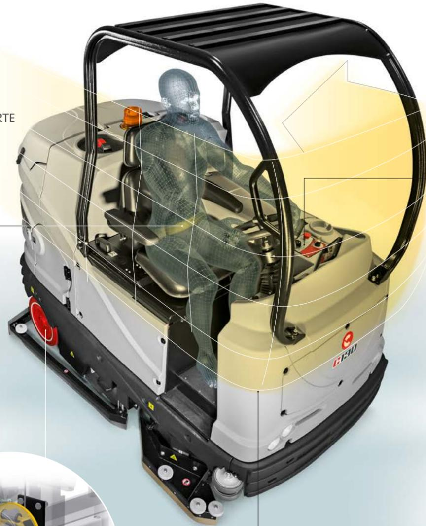
Nach der Auswahl der Arbeitskonfiguration muss sich der Bediener lediglich auf das Manövrieren der Maschine konzentrieren, dabei kann er den Blick stets ohne jede Ablenkung in Fahrtrichtung halten.
