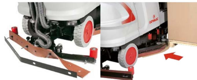
Schneller, werkzeugloser Wechsel des Sauggummis.
