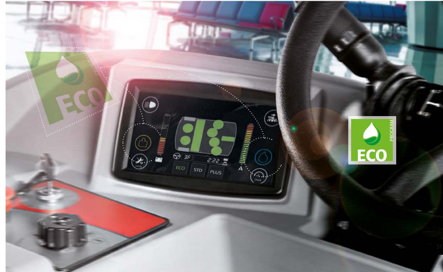
Bei der C130 kommen ressourcenschonende Technologien zum Einsatz. Beim Arbeiten im ECO-Modus werden nämlich die Abgabe von Wasser, Reinigungsmittel und Druck auf ein Minimum reduziert. Die ECO-Funktion beugt die Wasser-, Reinigungsmittel- und Energieverschwendung vor, indem lediglich die Menge verwendet wird, die auch wirklich benötigt wird.
