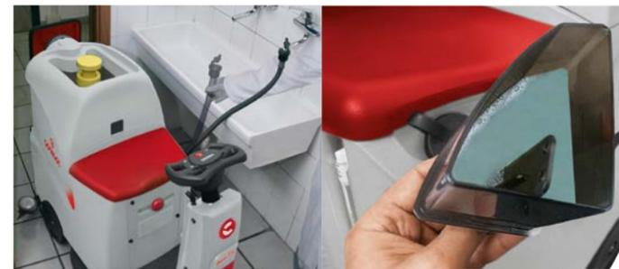
Frischwassertank mit Schnellbefüllsystem.
