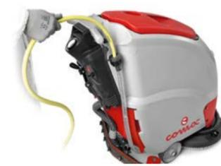
Schnelle Frischwasserbefüllung durch serienmäßigen Schlauchanschluss.
