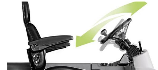
Passend für jeden Bediener: schnelle Einstellung des Sitzes und des Lenkrads
