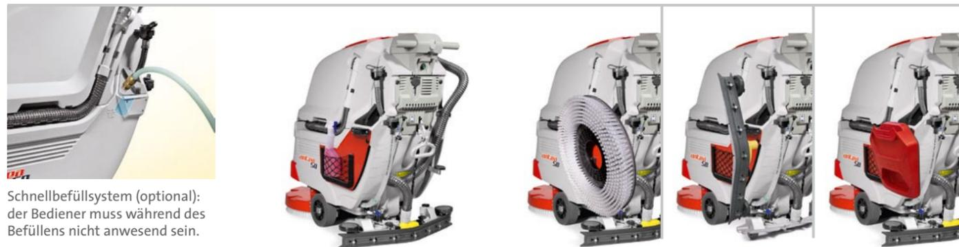
Schnellbefüllsystem (optional): der Bediener muss während des Befüllens nicht anwesend sein.
