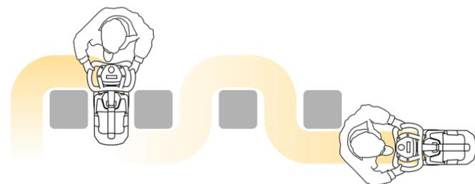
Die Bürsteneinheit verstellt sich seitlich zum Maschinengestell und ermöglicht dadurch die perfekte Reinigung entlang von Wänden.
