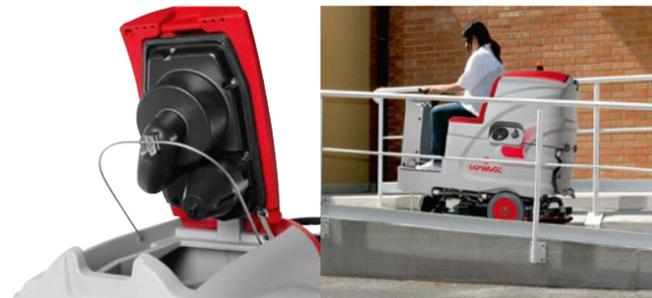
Extrem leiser, langlebiger, gekapselter Saugmotor macht die Maschine für Anwendung in geräuschempfindlichen Bereichen attraktiv. Steigfähigkeit bis 10%.
