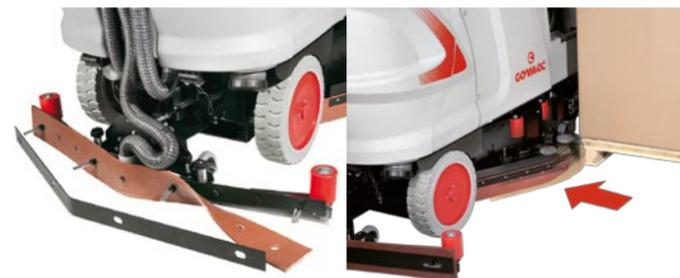
Schneller, werkzeugloser Wechsel des Sauggummis.
