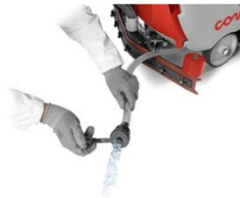
Leichte Entleerung des Frischwassertanks über einen Schlauch.
