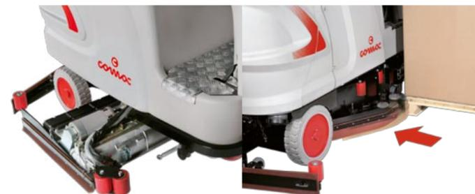
Leicht wechselbarer Walzenbürstkopf (Schrubben und Kehren).
