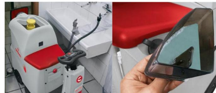
Frischwassertank mit Schnellbefüllsystem.
