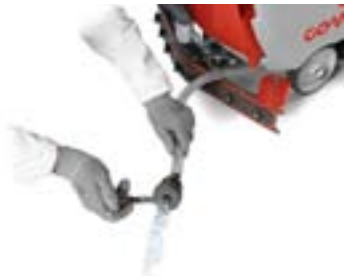
Leichte Entleerung des Frischwassertanks über einen Schlauch.
