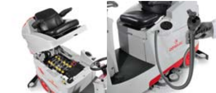
Gut zugänglicher Batterieraum.
