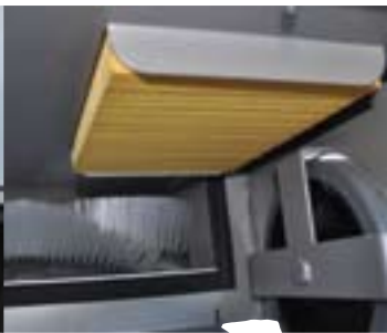
Der Staubfilter der Sweep 41 plus ist leicht zu wechseln und zu reinigen.
