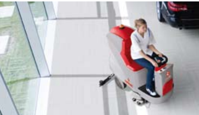
Extrem leiser, langlebiger, gekapselter Saugmotor macht die Maschine für Anwendung in geräuschen-siblen Bereichen attraktiv. Steigfähigkeit bis 10%.
