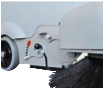
Sweep 41 plus: die Bürsthöhe ist schnell und leicht veränderbar.
