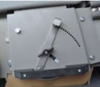
Sweep CS60 AB: einfache Verstellbarkeit der Bürsthöhe.
