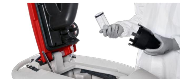
Tägliche Wartungsarbeiten sind leicht durchführbar (hier Reinigung des Saugmotorfilters).
