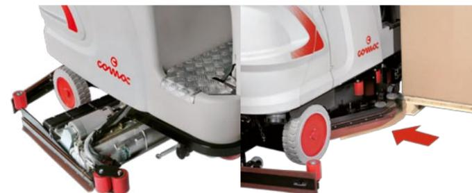
Leicht wechselbarer Walzenbürstkopf (Schrubben und Kehren).
