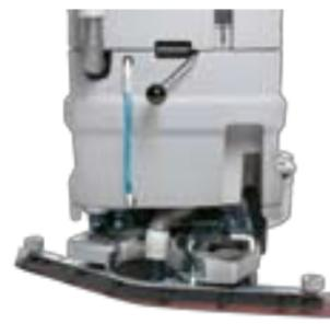
Füllstandsanzeige des Frischwassertanks (60 l).
