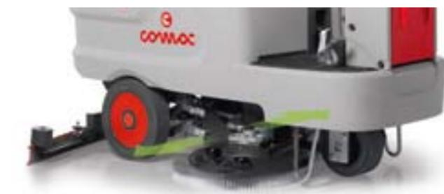
Die Innova 65 / 75 / 85 B Modelle sind mit einem Wechselmodul zur Anpassung der Arbeitsbreite ausgestattet.
