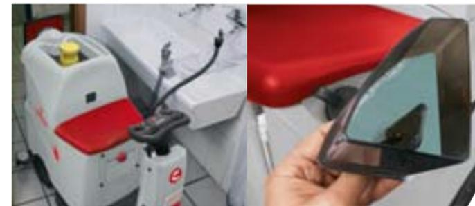
Schnellbefüllsystem des Frischwassertanks.
