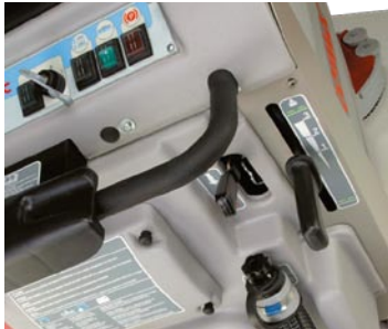
Bürstdruck in drei Stufen regulierbar. Sauglippen vierfach verwendbar und werkzeuglos abnehmbar.
