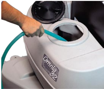
Schmutzwassertank leicht zugänglich und gut zu reinigen. Er hat einen langen Ablassschlauch und zwei große zusätzliche Öffnungen.
