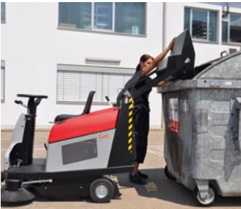
Sweep 71 AH: Hochentleerung bis 130 cm.
