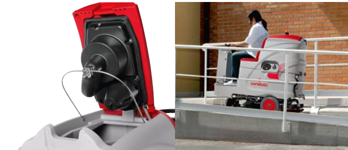
Extrem leiser, langlebiger, gekapselter Saugmotor macht die Maschine für Anwendung in geräuschsensitiven Bereichen attraktiv. Steigfähigkeit bis 10%.
