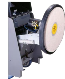
Leichter Padwechsel durch hochklappbare Poliereinheit.
