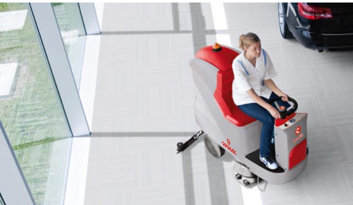
Extrem leiser, langlebiger, gekapselter Saugmotor macht die Maschine für Anwendung in geräuschsensitiven Bereichen attraktiv. Steigfähigkeit bis 10%.
