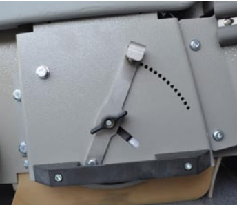
Sweep CS60 AB: Einfache Verstellbarkeit der Bürsthöhe.
