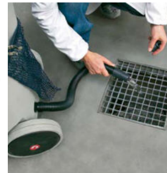
Ablassschlauch zum praktischen Entleeren beim CA 80 und CA 100.
