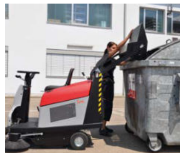
Sweep 71 AH: Hochentleerung bis 130 cm.
