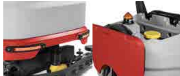
Alle Bestandteile der Maschine, die täglich gereinigt bzw. gewartet werden müssen, sind einfach an der gelben Farbgebung zu identifizieren.
