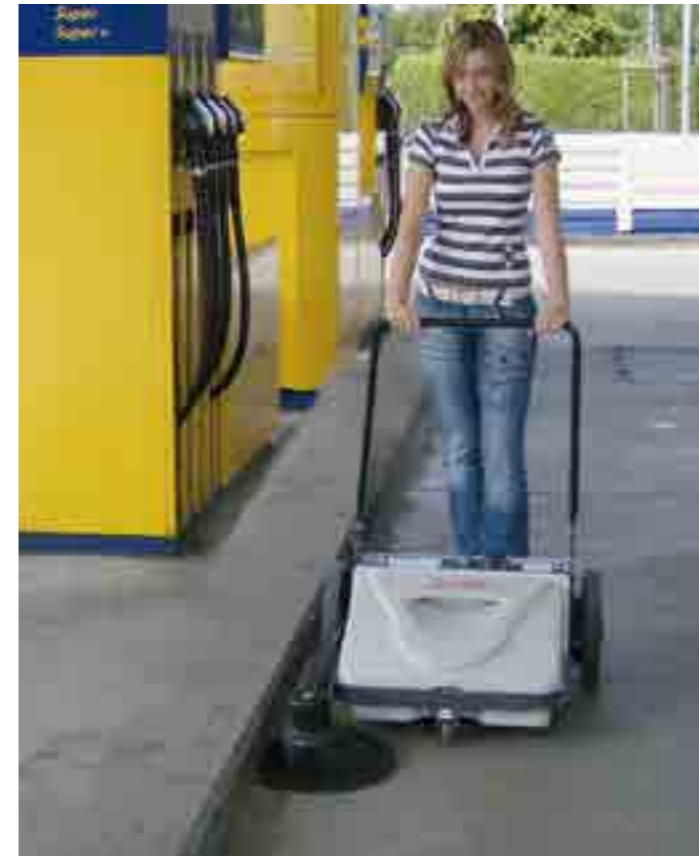
Sweep 5 Plus – mechanisch und doch mit Absaugung.
