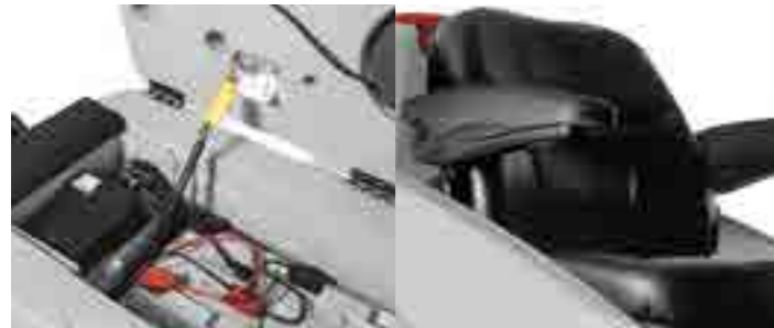
Sehr guter seitlicher Zugang zum Batterieraum. Die Gasdruckfeder hält den SW-Tank in aufgeklappter Position.
