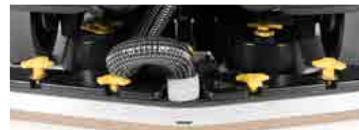
Jegliche Bestandteile, die täglich gereinigt bzw. gewartet werden müssen, sind einfach an der gelben Farbgebung zu identifizieren.
