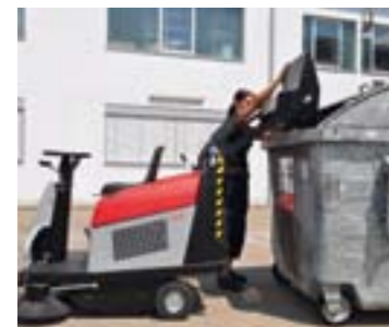
Sweep 71 AH: Hochentleerung bis 130 cm.
