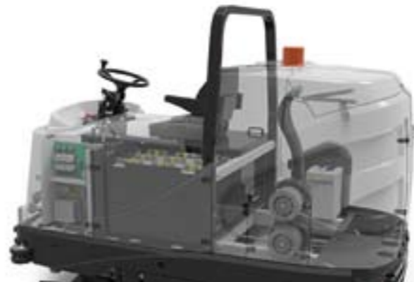
Seitlicher Zugang zu den Saugmotoren für eine schnelle Wartung.
