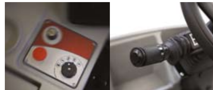
Einfachste Auswahl der Arbeitsprogramme über den Comac Drehschalter.
