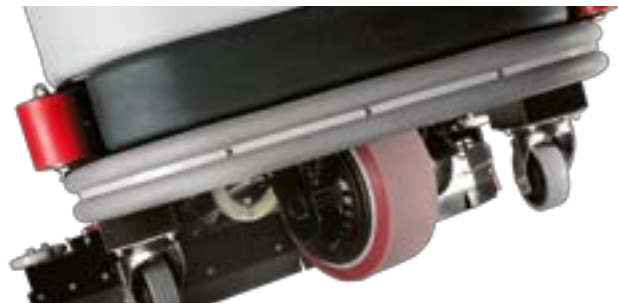
Antrieb über Vorderrad mit Gleichstrommotoren. Auf allen Ultras serienmäßig Anti-Skid-Räder.
