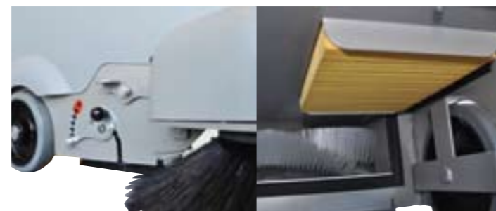
Sweep 41 Plus: die Bürsthöhe ist schnell und leicht veränderbar.
