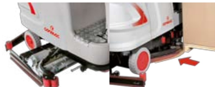
Leicht wechselbarer Walzenbürstkopf (Schrubben und Kehren).
