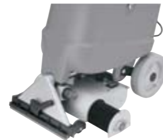
Spray X 12 brush: leicht wechselbare Teppichbürste.
