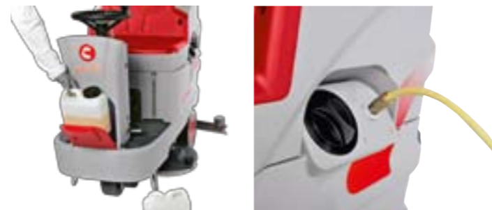
Die Innova 65 / 75 / 85 B Modelle können mit CDS (Comac Dosing System) für Wasser- und Chemiesteuerung ausgestattet werden.
