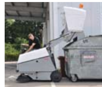
Hydraulische Hochentleerung bis maximal 158 cm und maximal 470 l (Sweep 120 AHD).
