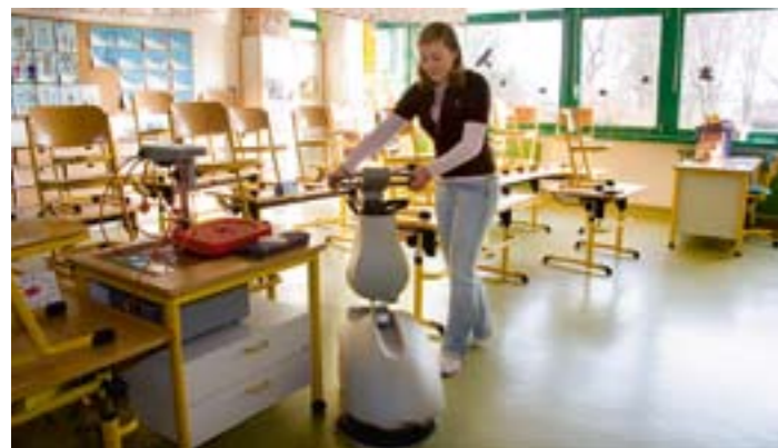
Vispa 35 B und 35 BS: Die Batterie kann in weniger als einer Minute werkzeuglos gewechselt werden.
