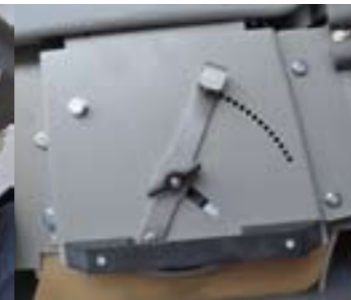
Sweep CS60 AB: Einfache Verstellbarkeit der Bürsthöhe.
