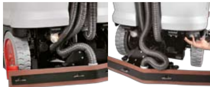
Schwerer Saugfuß für optimale Absaugung.
